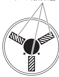
スポンジ貼付位置
